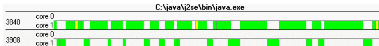
Abbildung 3 2 Threads mit gesetzter CPU Affinität auf CPU0, ohne Last
