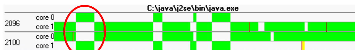
Abbildung 2 Verteilung von zwei Threads auf zwei CPUs
